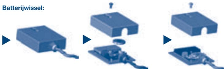
schroeven op het deksel losdraaien (kruiskopschroevendraaier)
