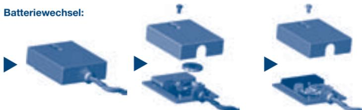
Schrauben am Deckel lösen (Kreuzschlitzschraubendreher)
