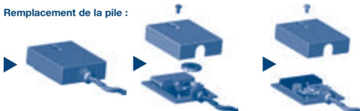
Desserrer la vis du couvercle (tournevis cruciforme)
