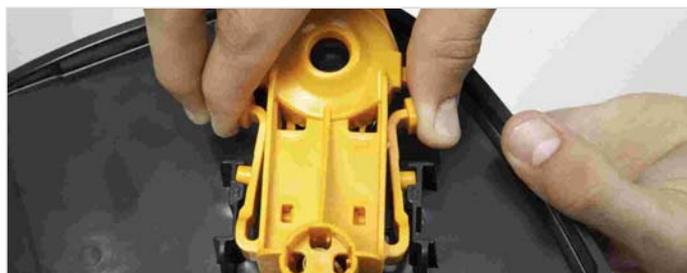
17. Pour démonter le robinet le cas échéant, faire pression sur les tiges latérales afin de désunir les pivots fixateurs.
