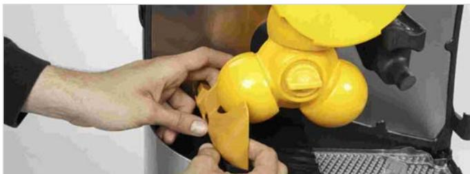
10. Replacer l'extracteur en l'insérant bien latéralement dans les pivots.
