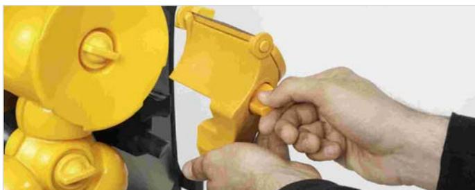
11. Insérer le groupe du couteau et enclencher l'axe de sécurité à l'inverse du démontage (indiqué: droite à gauche)
