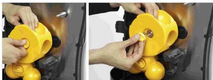
9. Relâcher les axes fixateurs des tambours du système de pressage.
