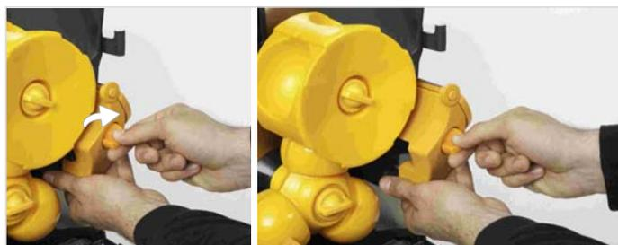
5. Détacher le groupe du couteau en tournant l'axe fixateur de sécurité sur 180° (gauche à droite).
