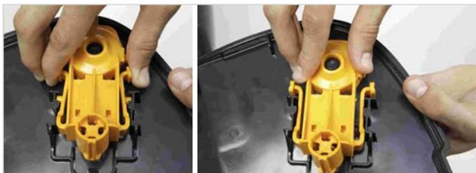
1. Placer le robinet sous le réservoir en appuyant sur les tiges latérales afin d'emboîter les pivots.
