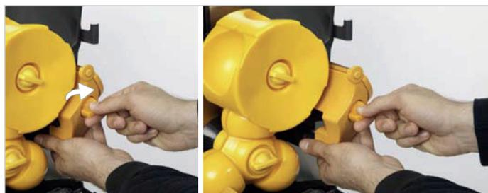
5. Entriegeln Sie das Messer indem Sie die Verriegelung um 180° drehen.
