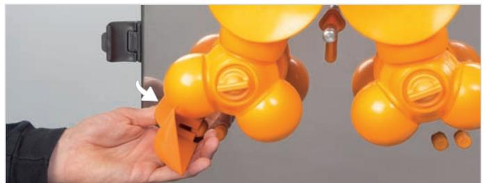
**14.** Stecken Sie die Schalenabstreifer fest auf. **Drücken Sie bis die Schalenabstreifer eingerastet sind um deren Bruch bei Benutzung der Maschine zu vermeiden**
