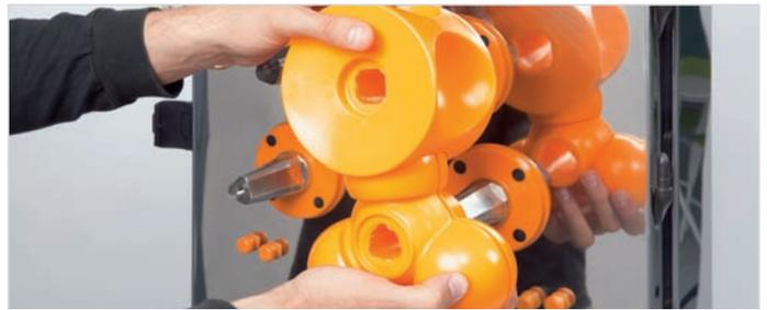
**12.** Stecken Sie die Presstrommeln paarweise auf.
