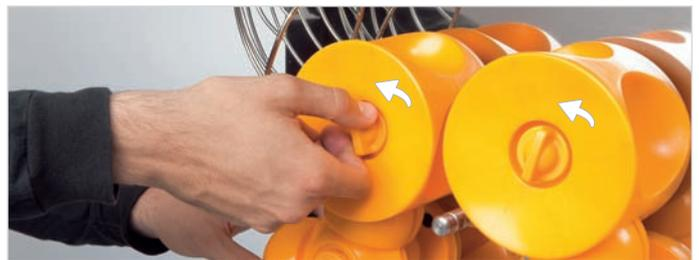
**6.** Lösen Sie die Sicherheitsschrauben der Presstrollern.
