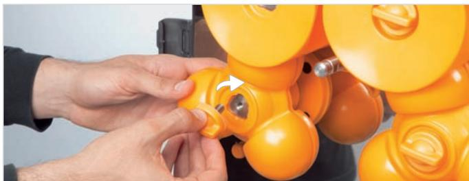
**13.** Schrauben Sie die Sicherheitsschrauben fest auf. **Fehlende Schrauben müssen unbedingt ersetzt werden. Die Maschine niemals ohne alle Schrauben benutzen.**
