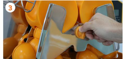
3 Schrauben Sie den mittleren Griff der Entsaftereinheit ab.
