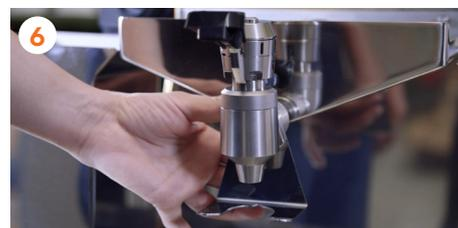
6 Montieren Sie den **2Services Zapfhahn** ab, der sich leicht herausschrauben lässt.
