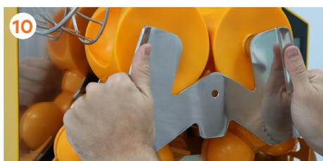
10 Heben Sie die **Entsaftereinheit** heraus, indem Sie sie an den seitlichen Griffen aus rostfreiem Stahl zu sich heranziehen.
