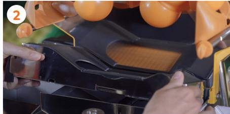
2 Nehmen Sie das automatische PulpOut System heraus, indem Sie die Vorrichtung an der Ihnen zugekehrten Seite anheben.
