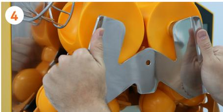
4 Nehmen Sie die Entsaftereinheit heraus, indem Sie sie an den Griffen aus rostfreiem Stahl zu sich heranziehen.
