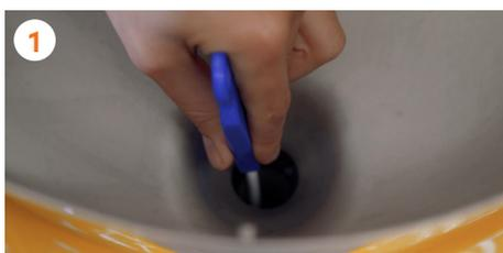
1 Führen Sie die Bürste in die **Drain&Clean** Öffnung an der Unterseite des Zuführers ein und entfernen Sie die Rückstände, die sich im Abflussrohr angesammelt haben.
