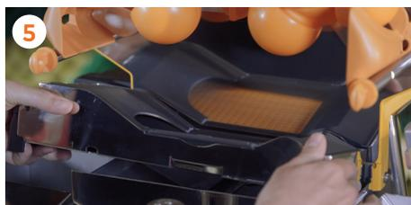
5 Entnehmen Sie das **automatische PulpOut System**, indem Sie die Vorrichtung an der Ihnen zugekehrten Seite anheben.
