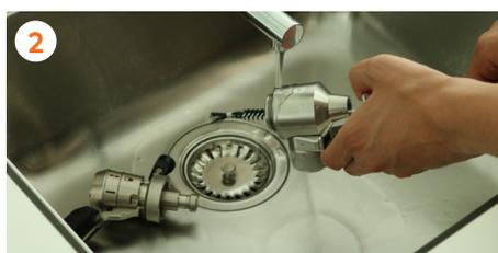
2 Reinigen Sie das Rohr und den Kolben mit der mitgelieferten Bürste, Wasser und Seife.
