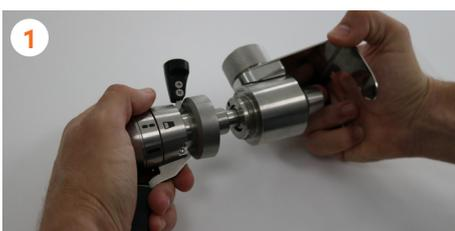
1 Montieren Sie den oberen Teil des **Zapfhahns** ab, indem Sie am matten Schraubgewinde drehen.
