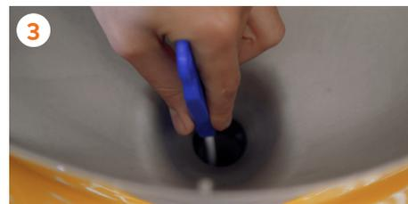
3 Führen Sie die Reinigungsbürste in die **Drain&Clean** Öffnung an der Unterseite des Zuführers ein und entfernen Sie die Rückstände, die sich im Rohr angesammelt haben.
