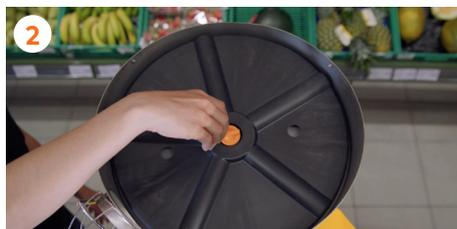
2 Entfernen Sie den **Zuführungsteller** indem Sie die orangene Verschraubung in der Mitte des Tellers herausschrauben.
