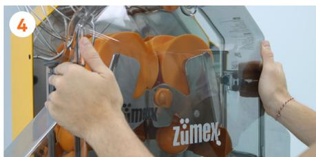
4 Drehen Sie an den Griffen und ziehen Sie die **vordere Abdeckung** mit den seitlichen Ausgangsöffnungen heraus.
