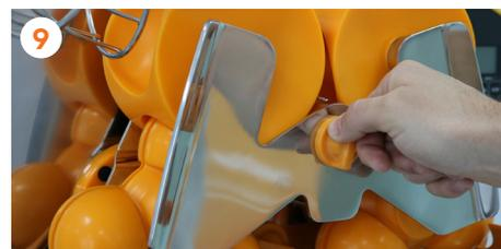
9 Schrauben Sie den mittleren Griff der **Entsaftereinheit** los.
