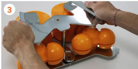
3 Heben Sie den oberen Teil an den **Griffen aus rostfreiem Stahl** hoch.
