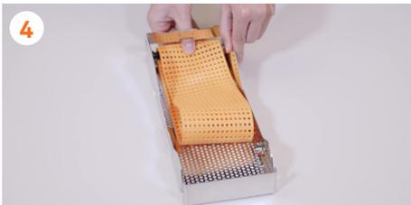
4 Ziehen Sie das **Filterband** zusammen mit der anderen Rolle heraus und entfernen Sie beide Teile.
