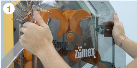
1 Drehen Sie an den Griffen und heben Sie die vordere Abdeckung mit den seitlichen Ausgangsöffnungen ab.
