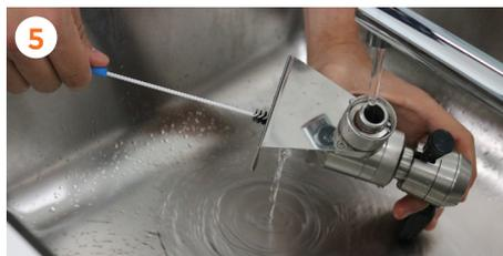
Reinigen Sie den **Zapfhahn** vollständig mit Wasser und Seife und spülen Sie das Rohr durch. Bürsten Sie gründlich die beiden Öffnungen sauber.
