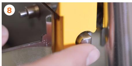
8 Entriegeln Sie die seitlichen Verschlüsse und ziehen Sie den **Saftbehälter** heraus.
