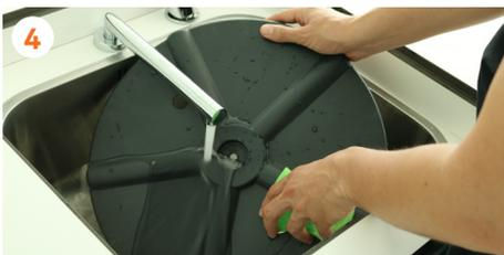
Reinigen Sie den **Zuführungsteller** mit einem weichen Schwamm und entfernen Sie alle Rückstände, die sich daran festgesetzt haben.
