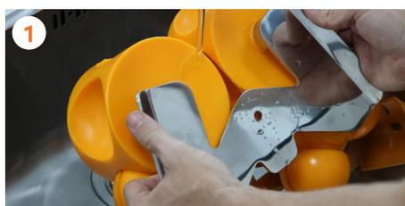
Spülen Sie die gesamte Entsaftereinheit in einem Stück unter dem Wasserhahn und reinigen Sie sie mit Wasser und Seife. Drehen Sie an den **Trommeln**, um sicherzustellen, dass alle Bereiche derselben sauber sind.
